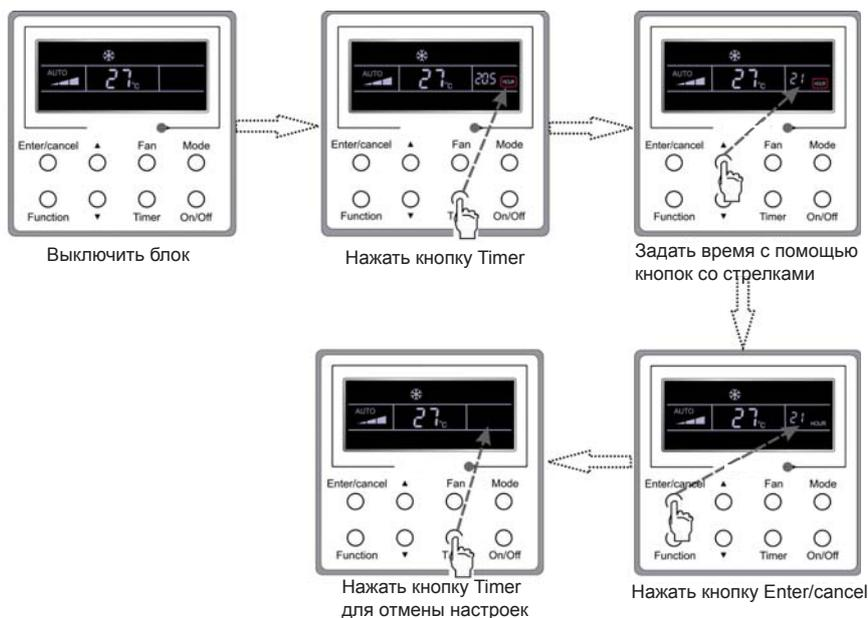
Рис. 8. Последовательность настройки таймера
