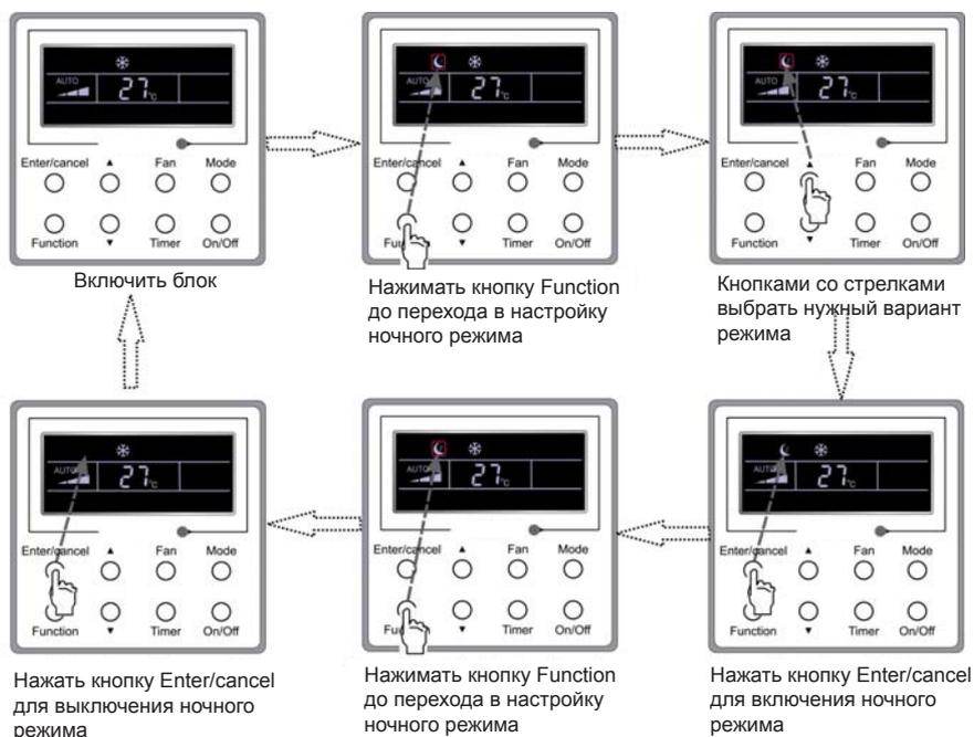
Рис. 10. Последовательность включения и выключения ночного режима
